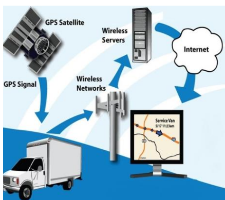
รูปที่ 1 หลักการทำงานของ GPS Tracking System
