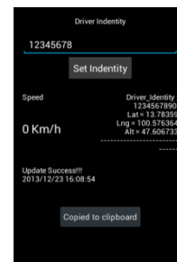
รูปที่ 11 แสดงตัวอย่าง Mobile Application ที่พัฒนาขึ้นเพื่อทำการทดสอบระบบตรวจจับอุบัติเหตุแบบ Real-time
