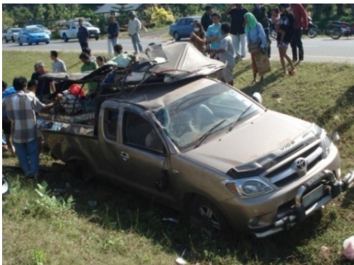
รูปที่ 7 จุดสุดท้ายของรถ กรณีอุบัติเหตุรถกระบะบรรทุก ยางระเบิดแล้วเสียหลักพลิกคว่ำ [23]
