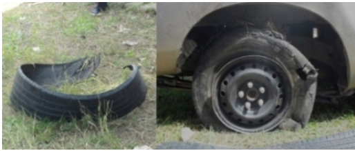
รูปที่ 6 สภาพหลังเกิดเหตุของล้อหลังด้านขวา กรณีอุบัติเหตุรถกระบะบรรทุก ยางระเบิดแล้วเสียหลักพลิกคว่ำ [23]
