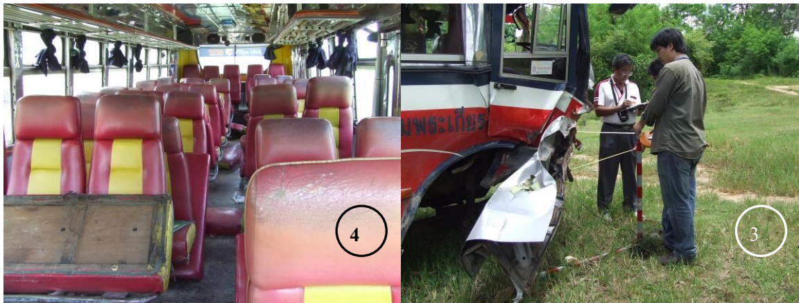
ข. การวัดและบันทึกระยะยวบตัวจากการชน และสภาพรถภายในห้องโดยสาร
