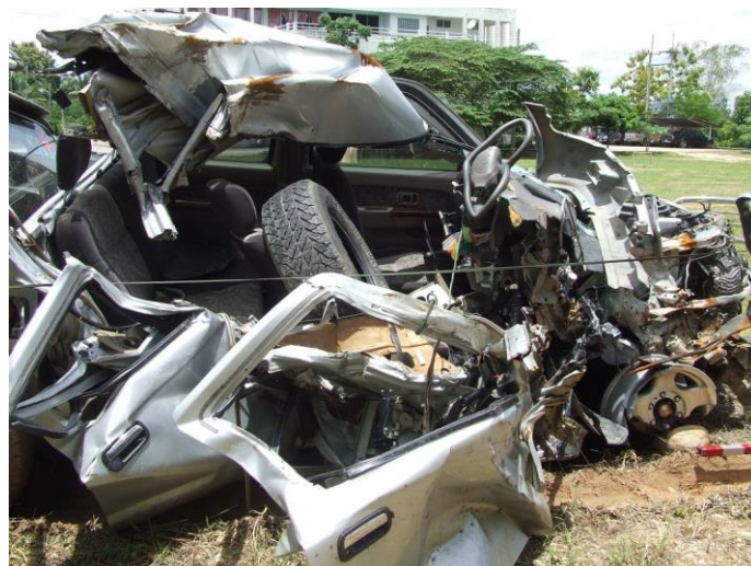
รูปที่ 3.3-18 สภาพภายในห้องโดยสารที่นั่งด้านคนขับเสียรูปร่างมากจากการชน
