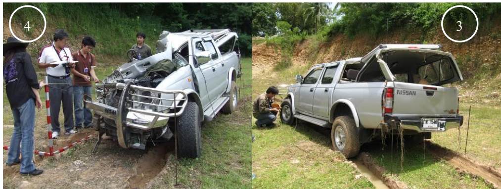
ข. การวัดความดันลมยางและวัดระยะยุบตัวของรถ
