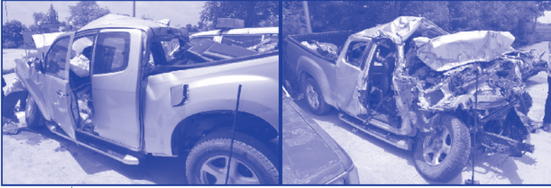
รูปที่ 5 สภาพเสียหายของประตูพาสซังเจอร์
