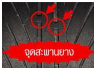
ภาพที่ 2-27 ความลึกของดอกยางเหลือ 1.6 มิลลิเมตร (ดอกยางสึกร้อยละ 80) (โยโกฮาม่า ไทร์ เซลล์ (ประเทศไทย), 2556)
