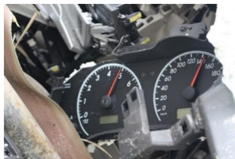
ภาพที่ 7 เข็มไมล์ของรถยนต์ที่ค้างหลังจากการชน
