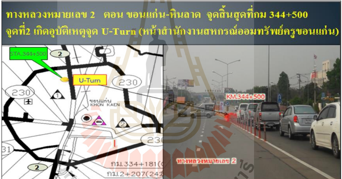
รูปที่ 2.7 การกำหนดจุดเสี่ยงอันตรายบนสายทางที่กม.343+436, กม344+500 (แขวงการทางขอนแก่นที่1, 2561)
