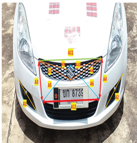
(ก) การวัดขนาดบนรถยนต์ที่ไม่ได้รับความเสียหาย (ข) การวัดขนาดบนรถยนต์ในแบบจำลองรูปที่ 6 ตำแหน่งการวัดระยะจริงและภาพขวาแสดงการวัดระยะจากโมเดลสามมิติ
