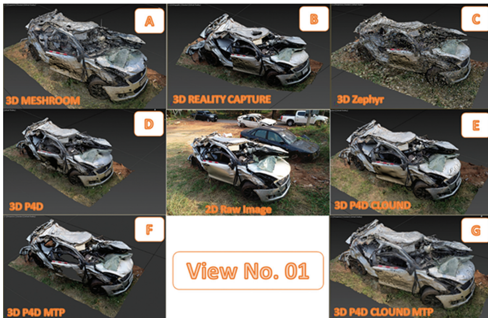
รูปที่ 5 การประมวลผลด้วยโปรแกรมแบบต่าง ๆ และการประเมินความครบถ้วนของแบบจำลองสามมิติ
