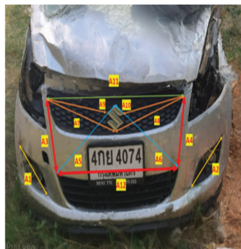
(ก) การวัดขนาดบนรถยนต์ที่ไม่ได้รับความเสียหาย (ข) การวัดขนาดบนรถยนต์ในแบบจำลองรูปที่ 6 ตำแหน่งการวัดระยะจริงและภาพขวาแสดงการวัดระยะจากโมเดลสามมิติ
