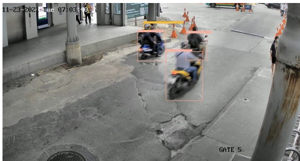
ภาพที่ 5 ระบบตรวจจับพฤติกรรมสวมหมวกนิรภัยขณะขับขี่รถจักรยานยนต์ในพื้นที่โรงพยาบาล ซึ่งนำมาใช้ในการประมวลผลภาพ (image processing) ซึ่งเป็นเทคโนโลยีใหม่มาประยุกต์ใช้ประกอบกับการติดตั้งกล้องวงจรปิดซึ่งครอบคลุมพื้นที่จราจรภายในโรงพยาบาลศิริราช
